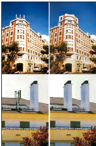
FIGURAS 9 e 10 - Exemplos de camuflagens que imitam a fachada do edifício
