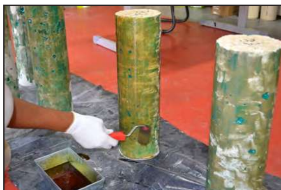
FIGURA 7 - Aplicação do primer.
