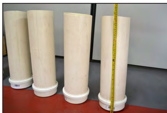
FIGURA 4 - Conferência da altura da forma dos corpos de prova.
