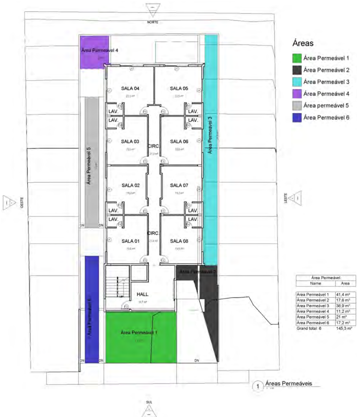
FIGURA 8 - Modelo tridimensional do edifício em software BIM detalhe do cálculo de área permeável.
