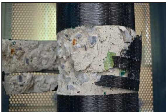
FIGURA 13 - Detalhe da região de rompimento do corpo de prova.
