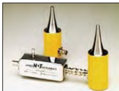
FIGURA 10 - Transdutores exponenciais (ou de ponta seca) de 54 kHz utilizado na pesquisa
