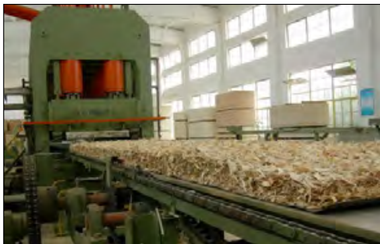
FIGURA 3 - Fabricação do OSB
