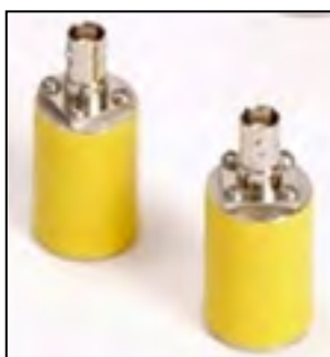
FIGURA 9 - Transdutor de 150 kHz utilizado na pesquisa
