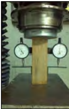
FIGURA 4 - Detalhe da montagem para ensaio de compressão
