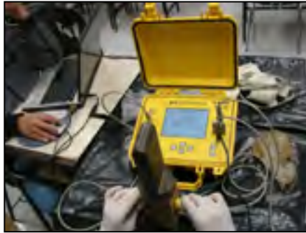
FIGURA 20 - Ensaio ultrassônico com transdutor exponencial de 150 kHz, ensaio perpendicular às fibras
