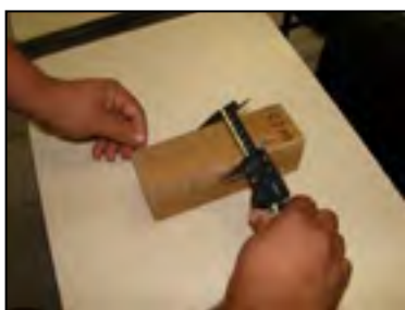
FIGURA 16 - Medida das dimensões do cp paralelas às fibras
