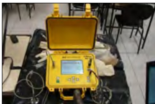
FIGURA 7 - Aparelho de ultrassom, V-METER MK III
