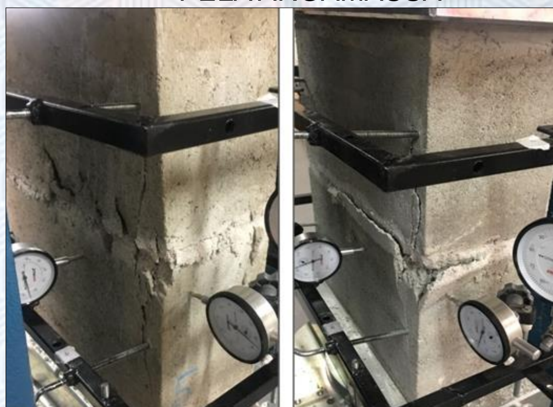
FIGURA 1: ROMPIMENTO DOS PRISMAS INICIANDO PELA ARGAMASSA
