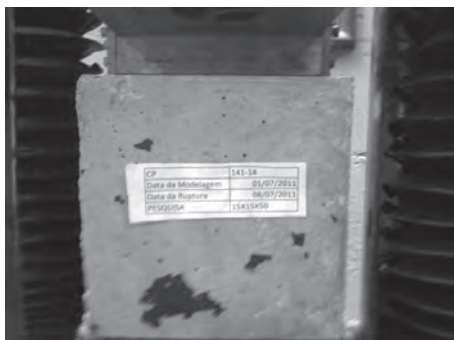
Figura 3 – Corpo de prova submetido ao ensaio de flexão.
