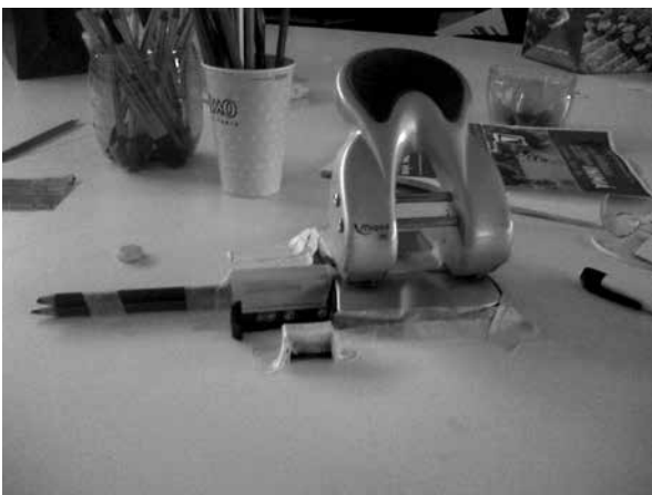
FIGURA 4 – Adaptação em furador de mão para montagem de um gabarito.
