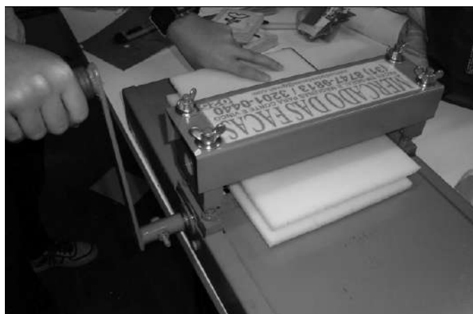
FIGURA 5 – O aluno Lucas operando o furador de papéis e, ao lado, a prensa para aplicar as facas especiais nas capas do bloquinhos.
