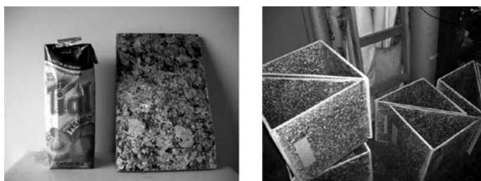
Fig. 4 e 5 - Caixa da Tetrapak transformada em placa e coletores.
