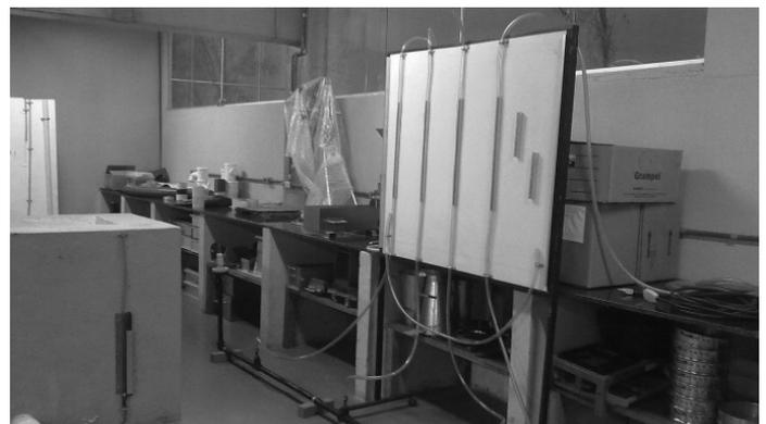
FIGURA 1 – Quadro de piezômetros.
