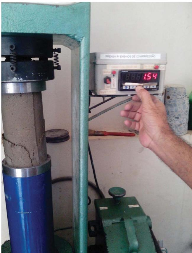
Figura 2 – Rompimento do corpo de prova
