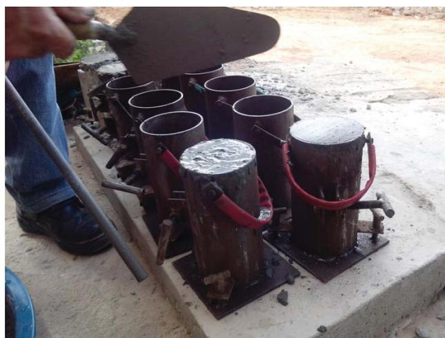
Figura 1 – Confecção dos corpos de prova
